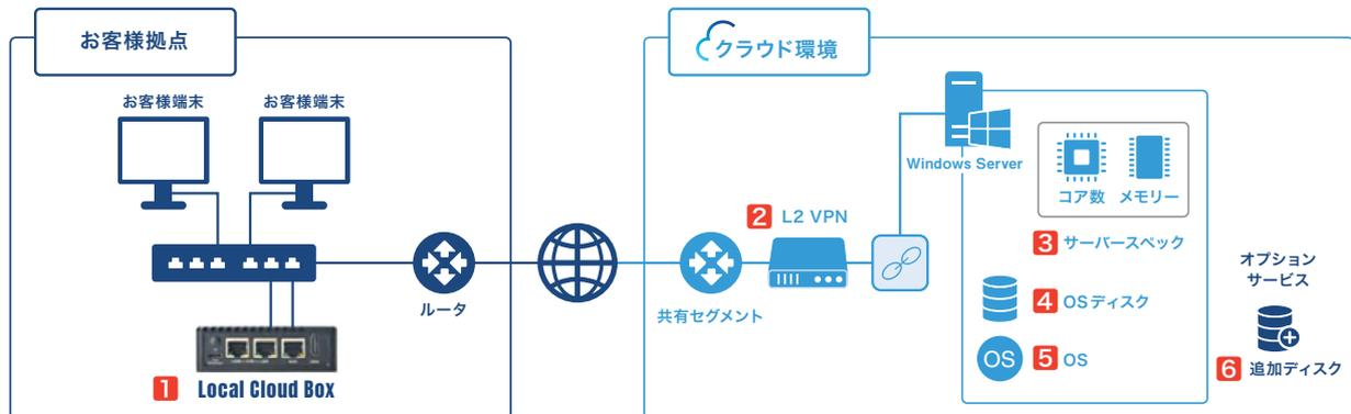
ファイルサーバーとして大容量のHDDを搭載したWindowsサーバーをご利用の場合の構成例です。サーバーは1台のみ、基本サービスで構成されます。
